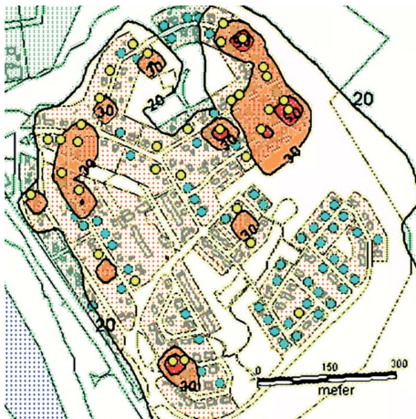
Beräknade PM10 halter i Furuvik, Lycksele. Den vänstra figuren visar 90-percentiler av dygnsmedelhalter och den högra figuren visar 98-percentiler av dygnsmedelhalter. Beräkningarna avser år 2001.
